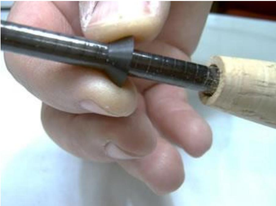
Questa operazione, consente sia di ottenere facilmente il diametro adeguato per il fissaggio della ghiera che il perfetto centraggio della ghiera stessa rispetto al grezzo. Per l'incollaggio, useremo la colla bicomponente, asportando eventuali tracce di colla in eccesso, con diluente al nitro.
